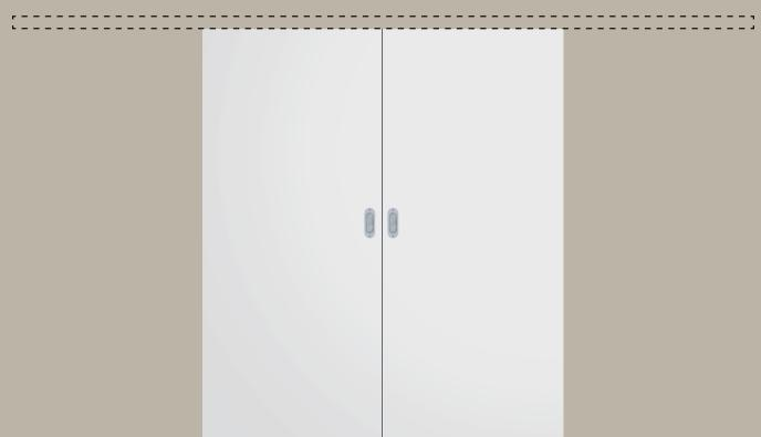
Перемещение в стене: дверное полотно задвигается в дверной «карман» в стене, коробка полностью по периметру закрывает проем в стене.
