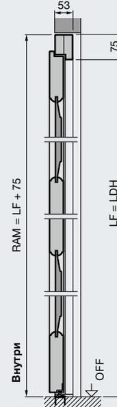
Боковая дверь из массивной древесины
