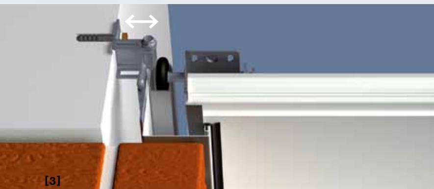
**[3]** Монтаж на ненесущую стену (облицовочный кирпич или теплоизоляция) с мин. 90 мм / макс. 125 мм бокового упора
