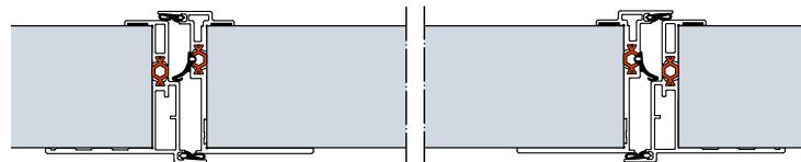
Конструкция калитки с термическим разделением для секционных ворот со строительной глубиной 67 мм
