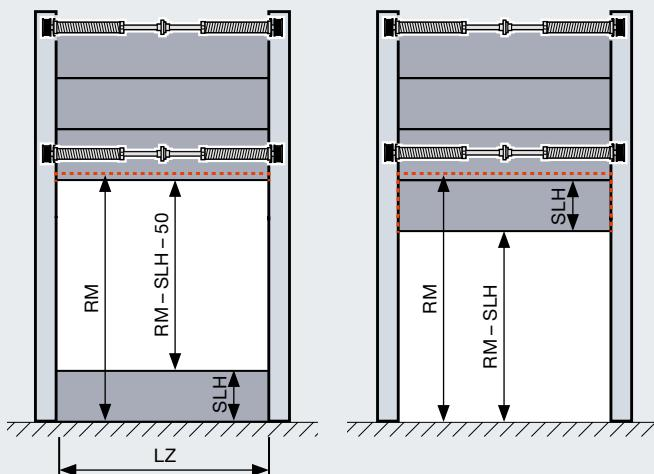
Если ворота открыты в соединенном состоянии (рис. справа), то секция цоколя со служебным мостиком остается в верхней части проема.
